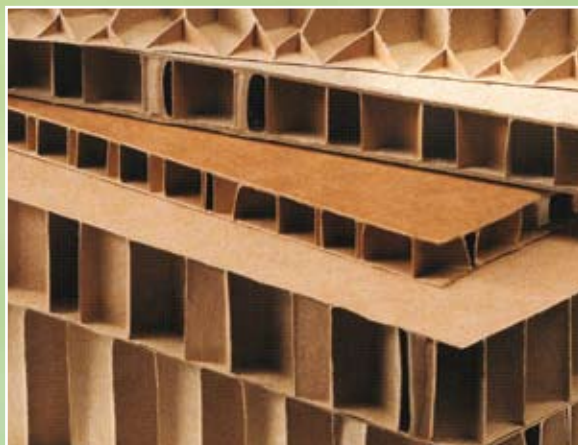
Cartón nido de abeja. Especial para embalajes con alta protección mecánica.
