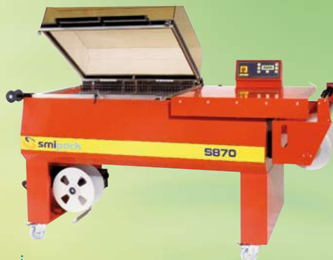
Retractor de campana. Gran formato. Barra soldante de 870 x 620 x 310 h.
