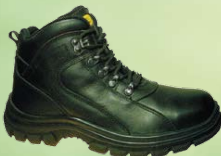
Bota de piel flor. Puntera y plantilla de acero. Suela PU de doble densidad. Tallas 38 a 47 Según normativa EN 345.
